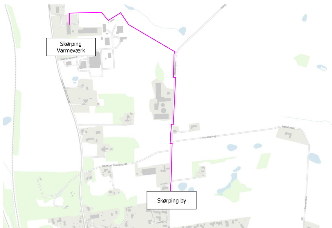
Figur 1.1: Skitse af forsyningsledningens tracé fra Skørping Varmeværk til Skørping by.
